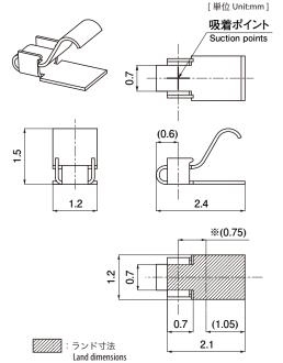
※吸着ポイント中心とランド中心のオフセット距離 ※ Distance between suction points center and land center
